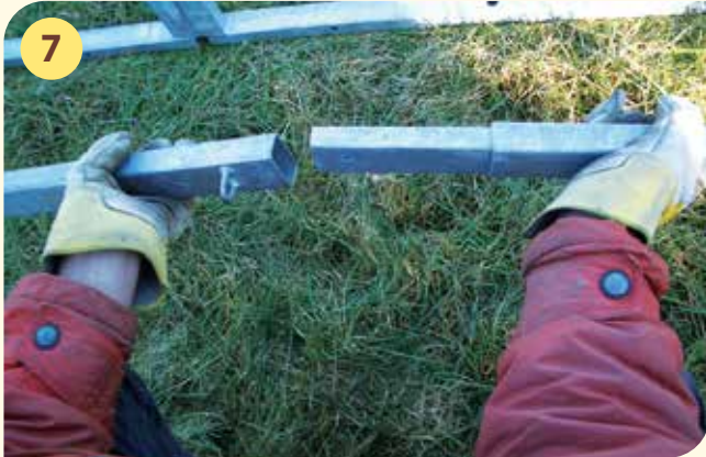
Vierkant-Verbindungsstücke ineinander stecken. D
