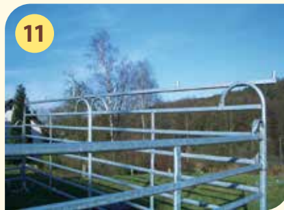
Vierkant-Verbindungsstück D auf die Seitenpanels legen und mit Befestigungswinkel L verschrauben (M8 x 70). Der Schraubenkopf muss nach außen zeigen.
